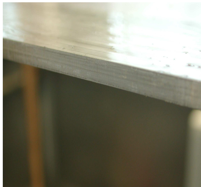
blacha cięta laserowo po obróbce głowicą do planowania
